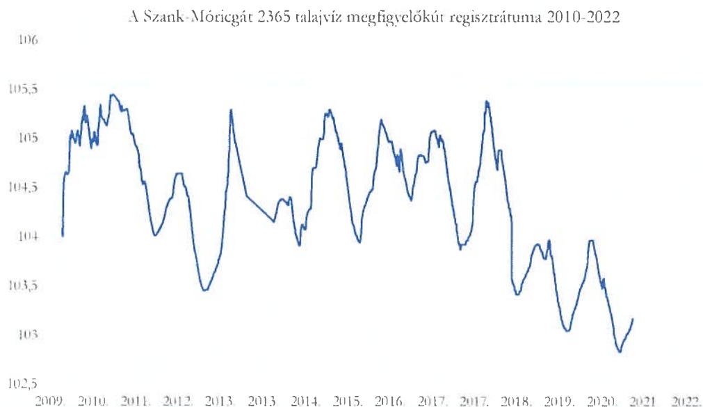
19. ábra: Szank-Móricgát 2365 talajvíz megfigyelőkút adatai
