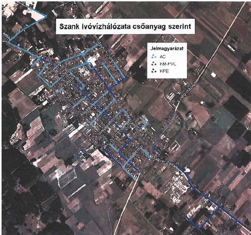
30. ábra: Ivóvízhálózat nyomvonala és csőanyag szerinti megoszlása
