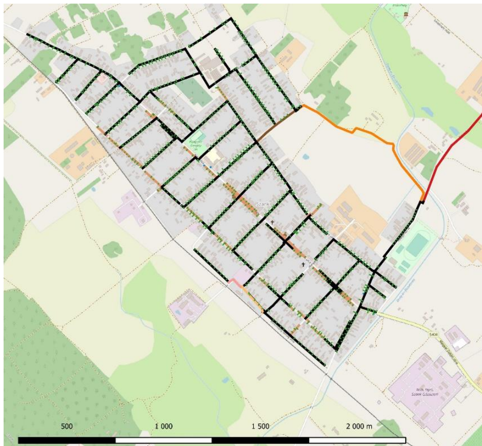
69. ábra: Szank település szennyvíz elvezető hálózata, anyagok és átmérők
